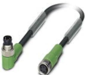
Кабель для датчика / исполнительного элемента, 4-полюсн., ПВХ, черный RAL 9005, Штекеры угловой M8, к Гнездо прямое M8, длина кабеля: 0,6 м
