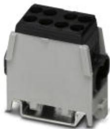
Ответвительный зажим магистрали, номинальное напряжение: 400 В, номинальный ток: 101 А, тип подключения: Винтовые зажимы, Винтовые зажимы, количество точек подсоединения: 4, полюсов: 1, сечение: 1,5 мм<sup>2</sup> - 25 мм<sup>2</sup>, AWG: 8 - 2, ширина: 23 мм, цвет: черный, тип монтажа: NS 35/7,5, NS 35/15
