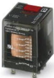
Базовое вставное промышленное реле с силовыми контактами, 4 переключ. контакта, тестовая кнопка, мех. индикатор коммутац. положения, входное напр.: 230 В AC
