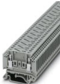
Клеммная колодка для подключения термопар, ТС тип N, номинальное напряжение: 400 В, номинальный ток: 1 А, тип подключения: Винтовые зажимы, количество точек подсоединения: 4, полюсов: 2, сечение: 0,2 мм<sup>2</sup> - 4 мм<sup>2</sup>, AWG: 24 - 12, ширина: 10,4 мм, цвет: серый, тип монтажа: NS 35/7,5, NS 35/15, NS 32
