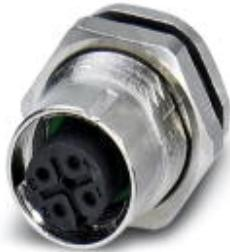
Встр. гнездо для датчика / исп. устр-ва, 4-контактн. с экранир. контактом, M12-SPEEDCON, с мех. ключом A, монтаж на задней панели / резьбовое крепление M16, с прямыми выводами под пайку
