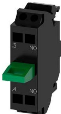
Контактный модуль с 1 контактным элементом, 1 НО, подключение на пружинных клеммах, для монтажа на полу, минимальный заказ 5 или кратное количество
