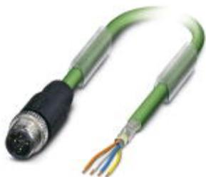
Системный кабель шины, PROFINET CAT5 (100 Мбит/с), 4-полюсн., ПВХ/ПВХ, зеленый RAL 6018, экранирован., Штекеры прямое M12, с механическим ключом D-типа, к свободный конец, длина кабеля: 5 м
