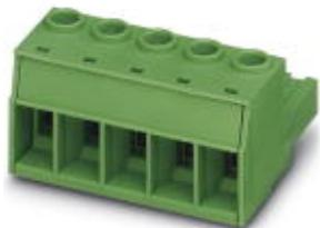
Разъемы для печатной платы, номинальный ток: 76 A, расчетное напряжение (III/2): 1000 В, полюсов: 6, размер шага: 10,16 мм, тип подключения: Винтовой зажим с натяжной гильзой, цвет: зеленый, поверхность контакта: Серебро
