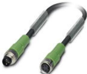
Кабель для датчика / исполнительного элемента, 3-полюсн., PUR без галогенов, темно-серый RAL 7021, Штекеры прямое M8, к Гнездо прямое M8, длина кабеля: 2 м
