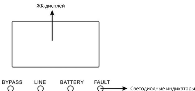
На передней панели расположены четыре светодиода, отображающих рабочее состояние ИБП:
