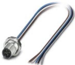
Встраиваемый разъем для датчика / исполнительного элемента, 5-полюсный, M12, с механическим ключом A, монтаж с задней части стенки / резьбовое крепление с Pg9, с гибким проводом 0,5 м (изоляция из TPE), 5 x 0,34 мм<sup>2</sup>, исполнение из нержавеющей стали
