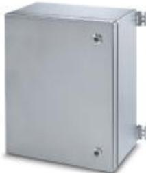
Клеммная коробка, материал: Высококачественная сталь 316L / 1.4404, поверхностное сопротивление: сатинированный, серебристый, 600 мм x 400 мм x 210 мм, тип замка: Дверь со сменным шарниром, комплект поставки - ATD: Дверной шарнир с затвором на четверть оборота, Монтажная плата, ключ с двумя бородками, Крепежный кронштейн в комплекте с винтами, Штифты заземления M12, расположенные снаружи, Инструкция по монтажу, Дверной шарнир с затвором на четверть оборота
