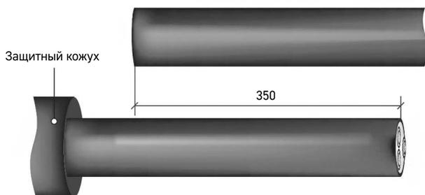
**1.1** Распрямить один конец кабеля на длине 2000 мм, другой — 1500 мм, очистить их от загрязнений и расположить их друг напротив друга с перехлестом в 350 мм.
