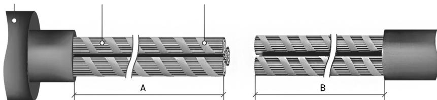
**2.1** Удалить с кабеля оболочку и межфазный наполнитель согласно рисунку и таблице (разделка на размер А должна проводиться со стороны кабеля с надетым кожухом).
