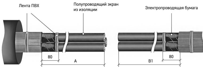
**2.3** На расстоянии 80 мм от среза наружной оболочки кабеля на слой черной электропроводящей бумаги (полимерной ленты) каждой жилы наложить бандаж из 2–3 слоев изоляционной ленты ПВХ. Удалить электропроводящую бумагу (полимерную ленту) на каждой жиле по краю наложенного бандажа. Изоляционную ленту не удалять. Повторить операции для второго конца кабеля.
