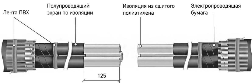
**4.1** Специальным инструментом (роликовым ножом) удалить слой черного полупроводящего экрана по изоляции из экструдированного сшитого полиэтилена с каждой жилы обоих концов кабеля на длину 125 мм от среза кабеля.
