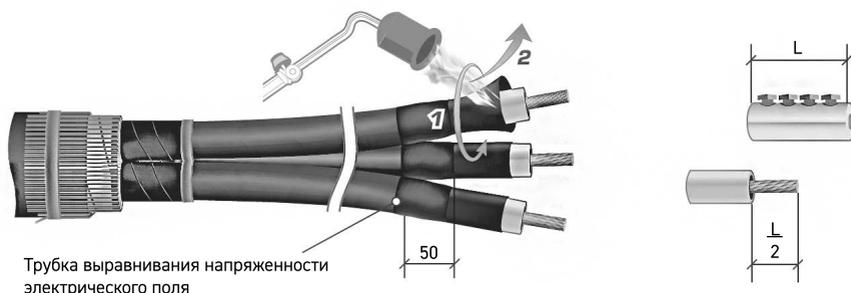
**5.1** Снять с концов всех жил изоляцию на длине, равной  $1/2$  длины гильзы (соединителя). Если используется соединитель с внутренней перегородкой, изоляция удаляется на участке, равном длине соединителя до перегородки.
