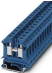
Проходные клеммы, номинальное напряжение: 800 В, номинальный ток: 57 А, тип подключения: Винтовые зажимы, количество точек подсоединения: 2, сечение: 0,5 мм<sup>2</sup> - 16 мм<sup>2</sup>, AWG: 20 - 6, ширина: 10,2 мм, цвет: синий, тип монтажа: NS 35/7,5, NS 35/15, NS 32
