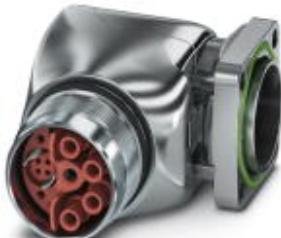
Приборный соединитель, передняя часть стенки, угловой, поворотный, для стандартной блокировки и SPEEDCON, M23, Полясов: 4+4+4+PE / 3+N+PE, тип контактов: Розетка, Обжим, Аксиальное уплотнительное кольцо, 4x Ø 3,2, размер фланца: 28 мм x 28 мм
