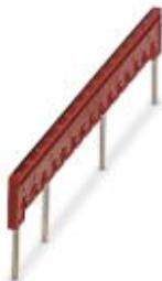
Перемычка, переходной, размер шага: 8,2 мм, ширина: 129,5 мм, полюсов: 16, расположение полюсов: 1, 7, 13, 16, цвет: красный
