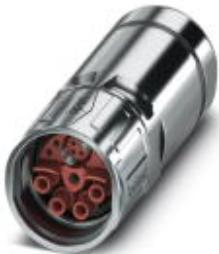
Кабельный соединитель, прямой, длинный, экранирован.: есть, Крепление SPEEDCON, M23, Полясов: 8+4+PE, тип контактов: Розетка, Обжим, диапазон диаметра кабеля: 7,5 мм ... 18 мм
