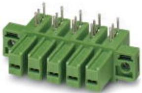
Корпусная часть для печатных плат, номинальный ток: 41 А, расчетное напряжение (III/2): 630 В, полюсов: 7, размер шага: 7,62 мм, цвет: зеленый, поверхность контакта: олово, монтаж: Пайка волной припоя
