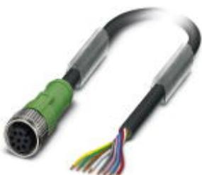
Кабель для датчика / исполнительного элемента, 8-полюсн., PUR без галогенов, темно-серый RAL 7021, свободный конец, к Гнездо прямое M12, А-кодирование, длина кабеля: 3 м
