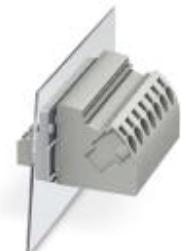
Проходная клемма, тип подключения: Пружинные зажимы Push-in, Подкл. плоского штекера, полюсов: 1, ток нагрузки: 18 A, сечение: 0,2 mm<sup>2</sup> - 4 mm<sup>2</sup>, AWG 24 - 12, ширина: 8,1 мм, цвет: серый
