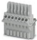
DUPLICON, контактная вставка соединителя, 6 x 4 мм<sup>2</sup> + PE, 400/690 В, 25 A, резьбовое соединение, тип B6, степень защиты IP20
