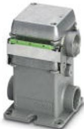
DUPLICON, алюминиевый комплект T-Box с контактной вставкой DUPLICON 6 x 4 mm<sup>2</sup> + PE с 2 винтовыми зажимами на полюс, исполнение В6, степень защиты IP67, 2 резьбовых кабельных ввода M20 (без кабельного сальника)
