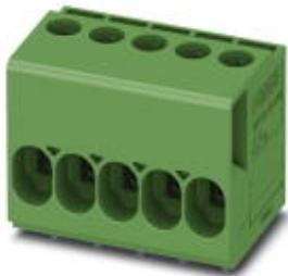
Клеммы для печатной платы, номинальный ток: 24 A, номинальное напряжение: 400 В, размер шага: 5,08 мм, полюсов: 5, тип подключения: Винтовой зажим с натяжной гильзой, монтаж: Пайка волной припоя, направление подключения, проводник/печатная плата: 0 °, цвет: зеленый
