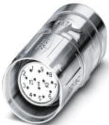
Кабельный соединитель, прямой, экранирован.: есть, Крепление SPEEDCON, M23, Полосов: 16+3, тип контактов: Розетка, Подключение пайкой, диапазон диаметра кабеля: 10 мм ... 14,5 мм
