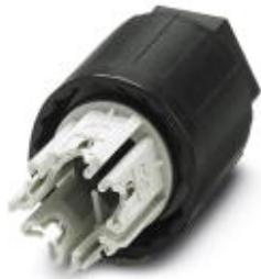
Гайка QUICKON, черная, кол-во контактов 4+PE, 2,5 мм<sup>2</sup> ... 6,0 мм<sup>2</sup> / 690 В / 40 А, для проводов диаметром 9 мм ... 14 мм.
