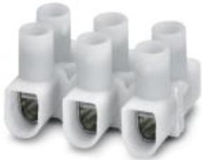
Группа евроклемм из полипропилена, белые, для соединения жестких и гибких проводников с кабельными наконечниками и без них, с сечением от 0,75 до 6 мм<sup>2</sup>, 3-контактные
