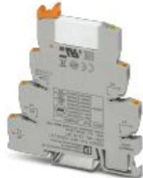
PLC-INTERFACE, состоит из базового клеммного модуля PLC-BPT.../21 с разъемом push-in с вставным мини-реле с многосл. золотым контактом, для монтажной рейки NS 35/7,5, 1 переключающий контакт, входное напряжение 230 В перем. тока/220 В DC
