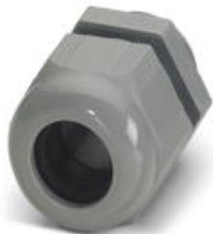
Кабельный ввод, материал резьбового соединения: PA, наружный диаметр кабеля 13 мм ... 18 мм, экранировка: нет, резьба соединительной части: Pg21, цвет: серебристо-серый RAL 7001
