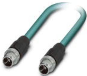
Сетевой кабель, Ethernet CAT6<sub>A</sub> (10 Гбит/с), CC-Link IE CAT6<sub>A</sub> (10 Гбит/с), 8-полюсн., PUR, цвет морской воды RAL 5021, экранирован., Штекеры прямое M12 SPEEDCON / IP67, механические ключи: X, к Штекеры прямое M12 SPEEDCON / IP67, механические ключи: X, длина кабеля: 2 м
