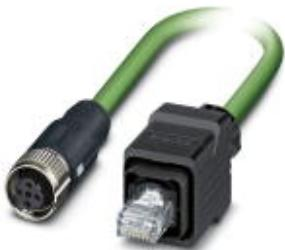
Сетевой кабель, PROFINET CAT5 (100 Мбит/с), EtherCAT® CAT5 (100 Мбит/с), 4-полюсн., ПВХ/ПВХ, зеленый RAL 6018, экранирован., Штекеры прямое RJ45 Крепление на защелках / IP67, к гнезду прямое M12 SPEEDCON / IP67, механические ключи: D, длина кабеля: 5 м
