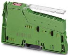
Inline, Релейная клемма, Релейный выход: 2 (сухие контакты), 24 В AC / 48 В DC, 2 A, для коммутации омических нагрузок, скорость передачи данных в локальной шине: 500 кбит/с, степень защиты: IP20, вкл. штекер Inline и поле для маркировки
