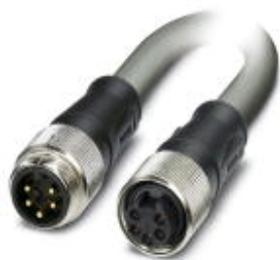
Силовой кабель, 5-полюсн., ПВХ, серый RAL 7001, Штекеры прямое 7/8"-16UNF, А-кодирование, к Гнездо прямое 7/8"-16UNF, А-кодирование, длина кабеля: 0,3 м, Сечение жилы 2,5 мм<sup>2</sup>, для питания
