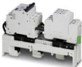
Комбинация из УЗИП класса II и входного предохранителя, с контролем разрядника, с индикатором состояния и контактом для дистанционной индикации. Исполнение: 4-проводные системы (L1, L2, L3, PEN), монтаж на 60-мм системную технику (шинные системы)
