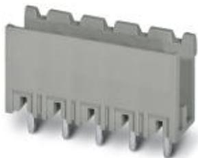
Корпусная часть для печатных плат, номинальный ток: 12 А, расчетное напряжение (III/2): 320 В, полюсов: 19, размер шага: 5 мм, цвет: сигнальный серый, поверхность контакта: олово, монтаж: Пайка волной припоя
