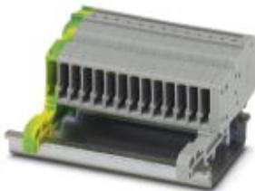
Соединитель COMBI, номинальное напряжение: 500 В, номинальный ток: 17,5 А, тип подключения: Зажимы Push-in, количество точек подсоединения: 1, полюсов: 14, сечение: 0,14 мм<sup>2</sup> - 1,5 мм<sup>2</sup>, AWG: 26 - 14, ширина: 49 мм, высота: 27,1 мм, цвет: серый/желто-зеленый, тип монтажа: NS 35/15, NS 35/7,5
