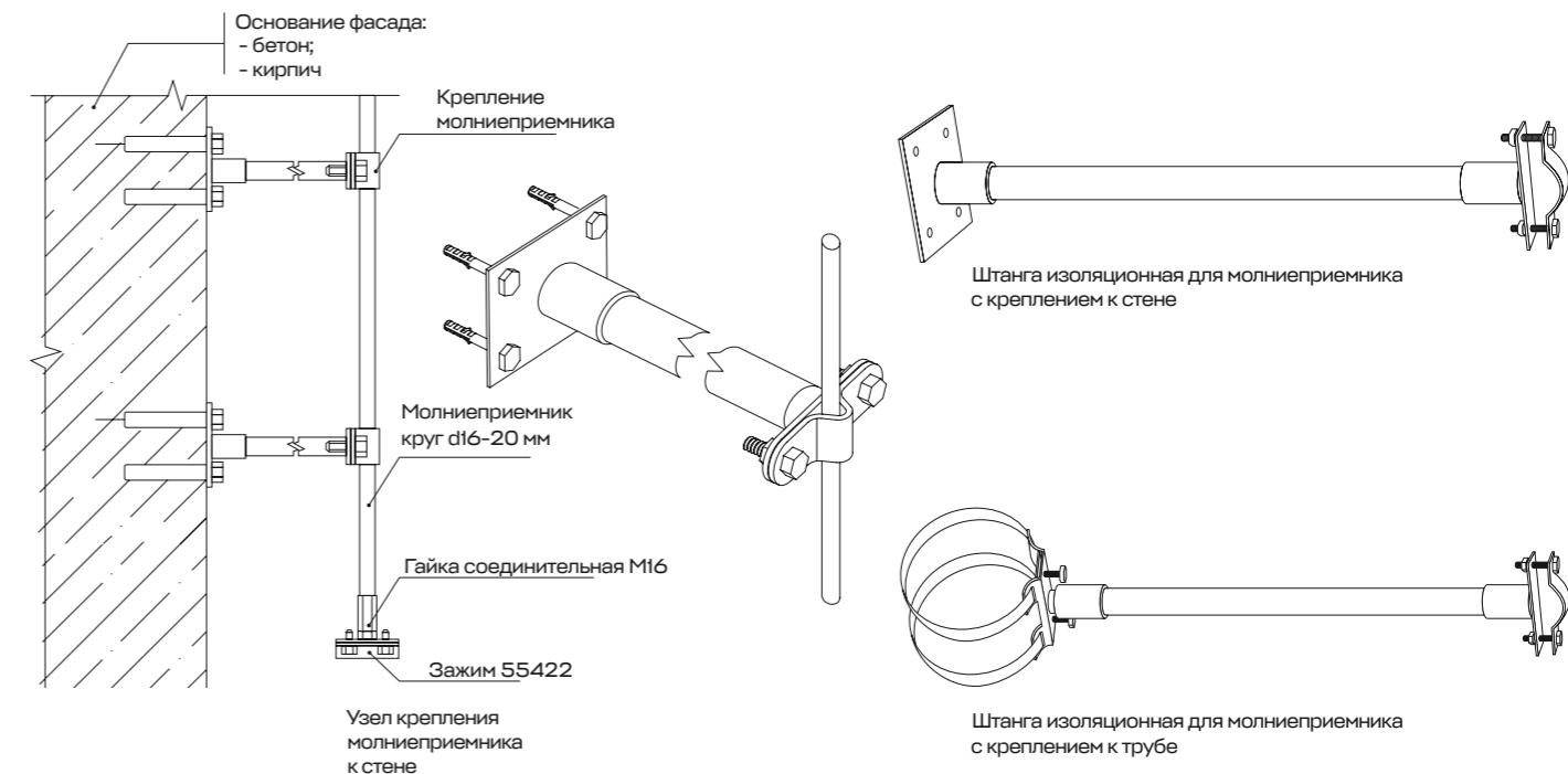
Штанга изолационная для молниеприемника с креплением к стене
