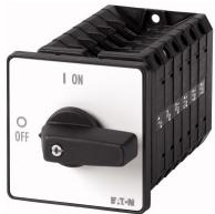
Ступенчатые выключатели, контакты: 12, 63 А, Передняя панель: 0-3, 45 °, с фиксацией, Монтаж
