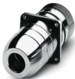
Проходная часть, задняя часть стенки, прямой, экранирован.: есть, Винтовой зажим, M23, Полюсов: 12, тип контактов: Розетка, Подключение пайкой, Плоское уплотнение, 4xM2,5, Толщина стенок, макс.: 2,5 мм, диапазон диаметра кабеля: 3 мм ... 10,5 мм
