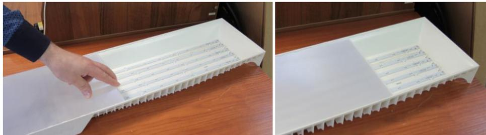
2) С другой стороны установить стекло в углы светильника, попадая под защелки. Середина стекла должна быть немного выгнута. Затем прижать стекло по сторонам светильника, защелкивая его окончательно.
