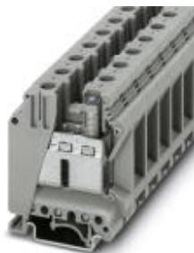
Проходные клеммы, с винтами с внутренним шестигранником, номинальное напряжение: 1000 В, номинальный ток: 150 А, тип подключения: Винтовые зажимы, количество точек подсоединения: 2, сечение: 0,75 мм<sup>2</sup> - 50 мм<sup>2</sup>, AWG: 18 - 1/0, ширина: 15,1 мм, цвет: серый, тип монтажа: NS 32, NS 35/7,5, NS 35/15
