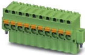
Разъемы для печатной платы, номинальный ток: 12 A, расчетное напряжение (III/2): 320 В, полюсов: 16, размер шага: 5 мм, тип подключения: Пружинные зажимы Push-in, цвет: зеленый, поверхность контакта: олово
