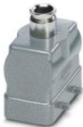
Сальниковый корпус HEAVYCON B10, для крепления двумя защелками, высота 56 мм, с резьбой 1x Pg16, прямой ввод кабеля
