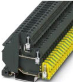
Разделительная клемма для датчика/исп. элемента, верхний ярус для разделительного или предохранительного штекера, шунтируемый вставными перемычками средний ярус для проведения сигнала, нижний ярус с основанием PE, номинальное напряжение: 250 В, номинальный ток: 15 А, тип подключения: Винтовые зажимы, количество точек подсоединения: 3, сечение: 0,2 мм<sup>2</sup> - 4 мм<sup>2</sup>, AWG: 24 - 10, ширина: 6,2 мм, цвет: темно-серая, тип монтажа: NS 35/7,5, NS 35/15
