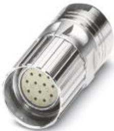
Кабельный соединитель, прямой, Винтовой зажим, M23, полюсов: 12, тип контактов: Розетка, Подключение пайкой, экранирован.: есть, диапазон диаметра кабеля: 5 мм ... 13,2 мм
