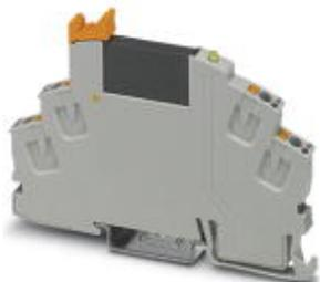
Предустановленный модуль полупроводниковых реле с зажимами push-in, состоящий из: установочного блока (основания) с выбрасывателем и вставного миниатюрного полупроводникового реле. Входное напряжение: 24 В DC. Выходное напряжение: 24-253 В AC/0,75 А
