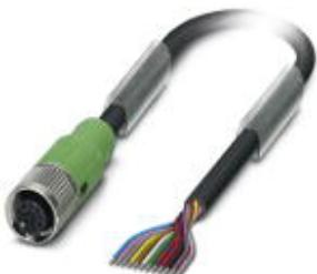
Кабель для датчика / исполнительного элемента, 12-полюсн., ПВХ, черный RAL 9005, свободный конец, к Гнездо прямое M12 SPEEDCON, А-кодирование, длина кабеля: 1,5 м
