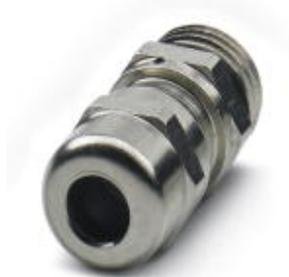
Кабельный ввод, материал резьбового соединения: латунь, никелированный, наружный диаметр кабеля 4 мм ... 7 мм, экранировка: нет, резьба соединительной части: M16 x 1,5, цвет: серебристый, с элементом компенсации давления и плоским уплотнением, с уплотнительным кольцом
