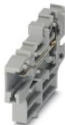
Соединитель COMBI, номинальное напряжение: 800 В, номинальный ток: 32 А, тип подключения: Пружинный зажим, количество точек подсоединения: 2, полюсов: 1, сечение: 0,08 мм<sup>2</sup> - 6 мм<sup>2</sup>, AWG: 28 - 10, ширина: 6,2 мм, высота: 31 мм, цвет: серый, тип монтажа: на монтажную пластину
