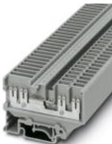
Проходные клеммы, номинальное напряжение: 800 В, номинальный ток: 32 А, тип подключения: Подкл. плоского штекера, количество точек подсоединения: 8, сечение: 0,5 мм<sup>2</sup> - 6 мм<sup>2</sup>, AWG: 20 - 10, ширина: 6,2 мм, цвет: серый, тип монтажа: NS 32, NS 35/7,5, NS 35/15
