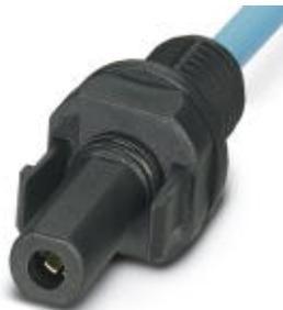
Фотогальванический штекерный соединитель, Соединитель для ФГ-системы, материал корпуса: PPE, цвет: черный, полюсов: 1, сечение жилы мин.: 2,5 мм<sup>2</sup>, расчетный ток: 27 А, Тип подключения: Обжим, Тип контактов: Розетка, длина кабеля: 300. деблокировка возможна только с инструментом
