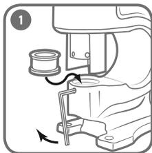
**Открутите** винты крепления матрицы в посадочное место. **Зафиксируйте** матрицу винтами.
