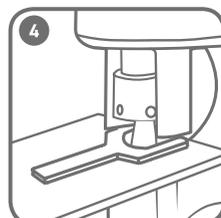
4 Установите съемник и сбросьте давление в системе с помощью внешней помпы. Винт сброса на инструменте должен оставаться закрытым!
